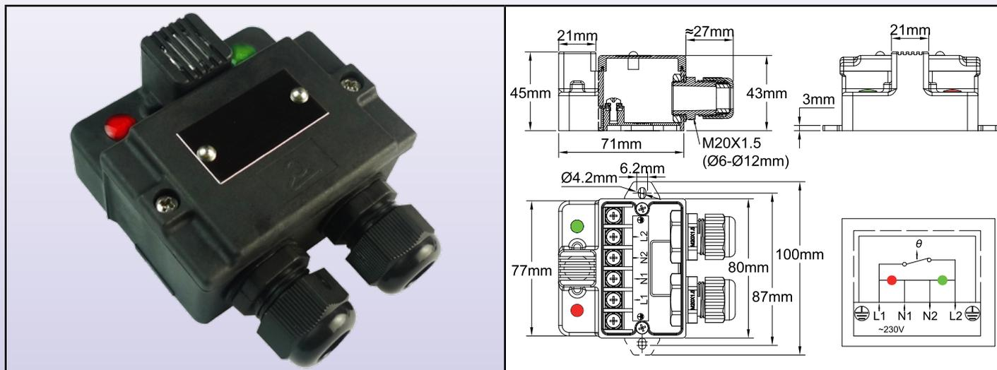
In queste scatole, il termostato, del tipo a disco bimetallico, è sovrastampato e isolato termicamente dalla parete su cui è montato. La coppa di rilevamento della temperatura è protetta meccanicamente da una griglia. È posizionato nella parte anteriore dell'alloggiamento, in modo da trovarsi in una zona di circolazione naturale dell'aria.
